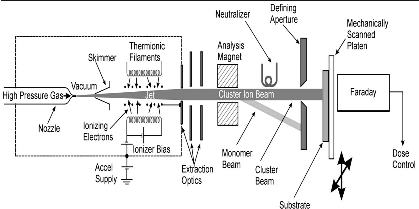
Fig. 1. A GCIB apparatus schematic.<sup>7</sup>
